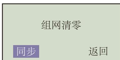
在多台张力器组网使用时可通过该功能进行同步清零校对，方便张力器的操作与管理。
