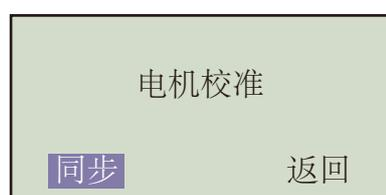
在张力器程序升级后，需进行电机编码器基准点校准。
