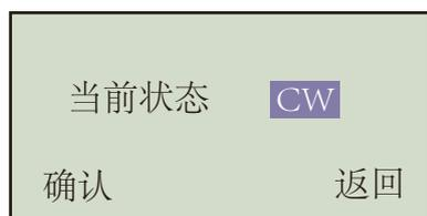
此功能可以改变电机的转向，CW为电机顺时针旋转，CCW为电机逆时针旋转。此功能操作后需要重启电源生效。
